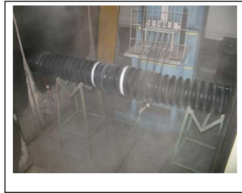
図13. 断熱特性 実験模様
