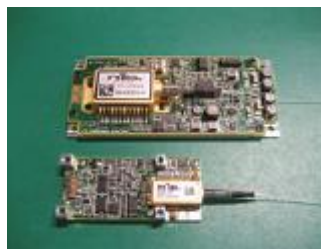
ITLA / 集積型信号光源（上段：従来型、下段：小型版）
