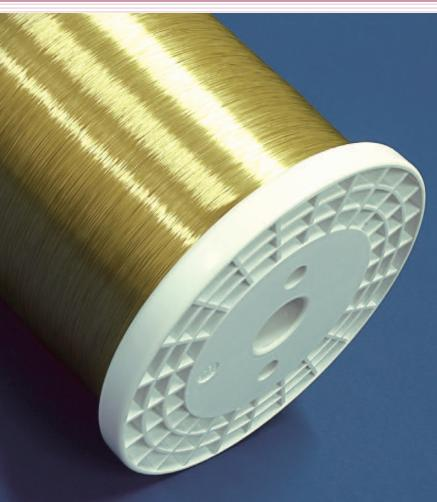
镀磁线 (磁性线) 是在铜导体圆周上包覆有强磁性的薄膜层,再在此薄膜层上烧结聚氨酯绝缘层的电线。用于各种高频线圈时,相比原来的聚氨酯铜线的高频损失率减低 10%。这是因为由于磁性层的存在,减轻了线圈产生的接近效应的影响,使导体的电流分布趋于均匀,减低了导体的实际电阻。
