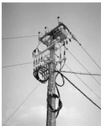
写真 4 屋外暴露試験（重汚損地区） Outdoor exposure test (heavy pollution area)
