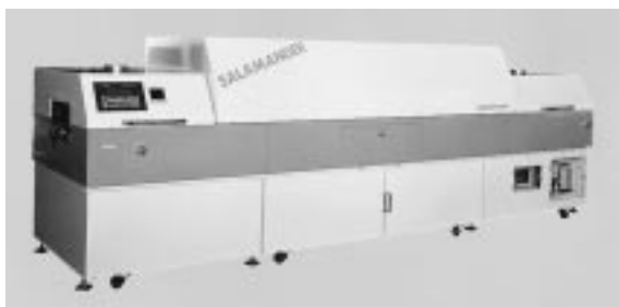
図1 窒素雰囲気リフロー炉「SALAMANDER-XN」 Reflow furnace "SALAMANDER-XN" using nitrogen atmosphere
