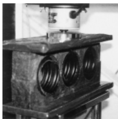
図3 φ 80 x 2条の圧縮試験 Compression test of φ 80 x 2 lines
