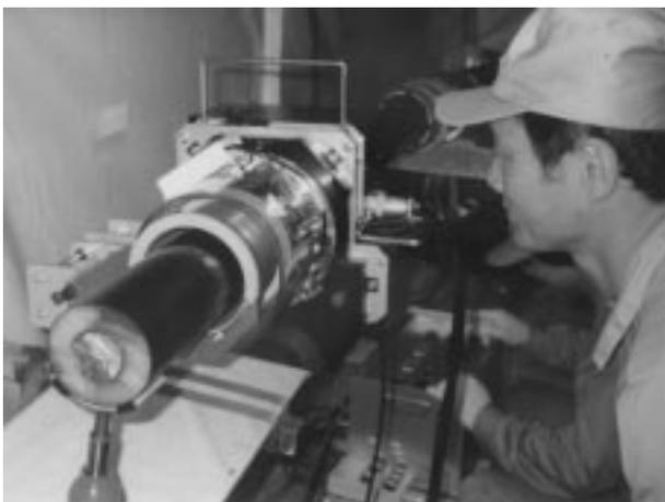
写真1 自走式外導削り機
