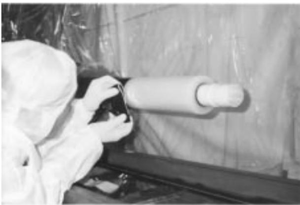
写真2 平行光線によるケーブル表面検査
