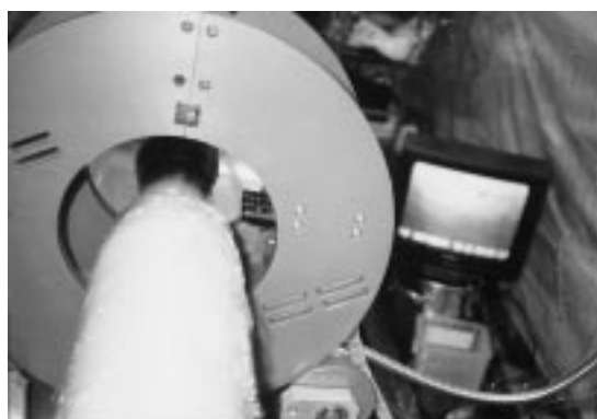
写真5 CCDカメラによる表面検査 Surface inspection using CCD camera
