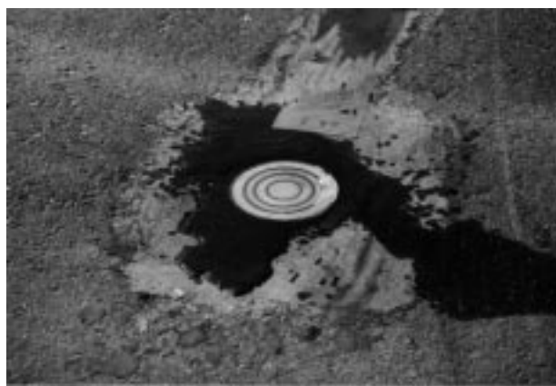
図9 散水された湿潤センサ Wet sensor mounted in the pavement
