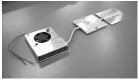
図3 RHE方式ヒートシンクの代表的タイプ Typical RHE heat sink for notebook computers
