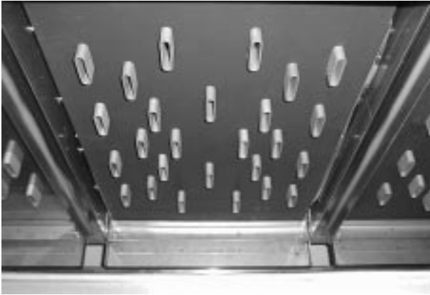
写真1 衝突噴流ノズル外観 Appearance of new nozzles
