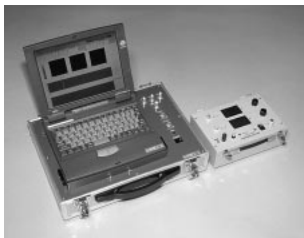
図4 ポータブル部分放電測定システム外観 Appearance of portable discharge measurement system
