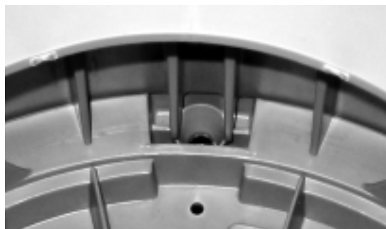
写真2 嵌合部の構造 Structure of the joint part
