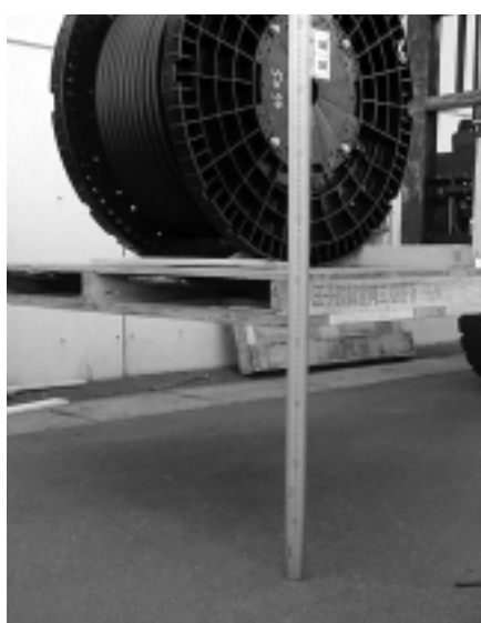
写真5 落下直前のドラム Drum just before a fall test (50 cm)
