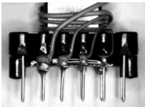
写真2 半田付け後のTEX-B TEX-B after soldering
