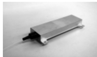
図4 ストークスアナライザモジュールの外観図 Appearance of Stokes analyzer module
