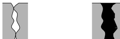
(a)金属面同士での接続 (b) T Mシートを使用しての接続
