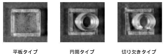
図 9 耐塵試験サンプル写真
