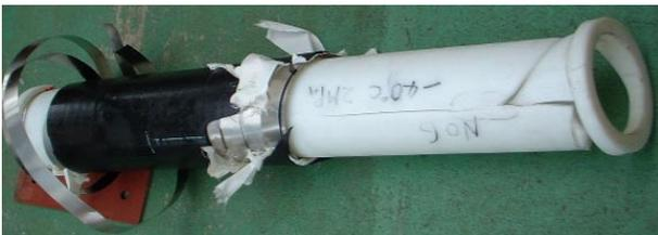
写真7 鋼帯補強PE管の衝撃試験後の試料
