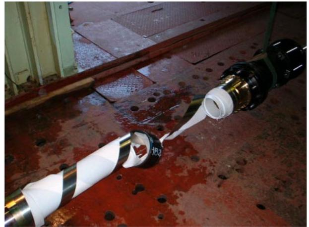
写真5 引張試験(破壊時)
