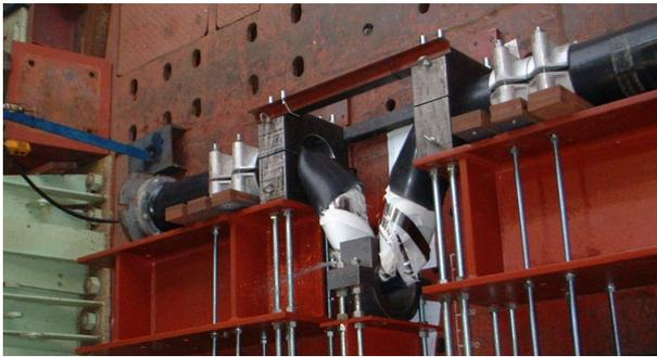
写真4 せん断試験(破壊時)
