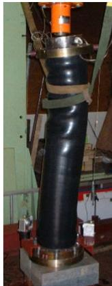
写真3 軸圧縮試験(座屈時)
