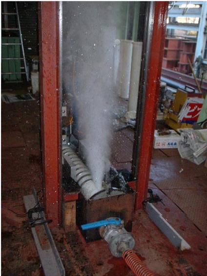
写真6 ポリエチレン管のS4試験状況
