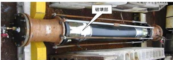
写真1 内圧破壊試験
