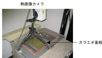
写真2 熱画像撮影 Thermal imaging using pyrometer
