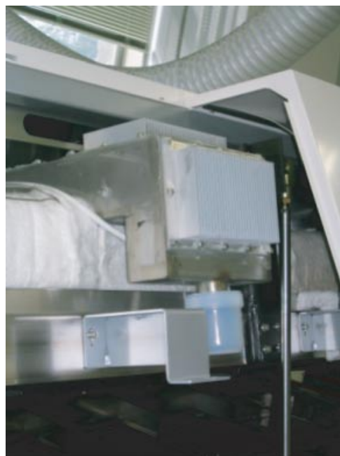
写真5 フラックス回収機構(中間部) Center unit of flux recovery system.
