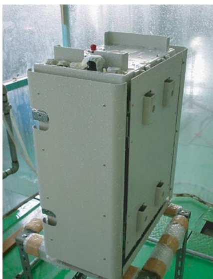
写真3 防水性能試験状況 Setup for water-tightness test.
