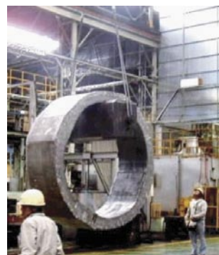
図3 大型リング鍛造品(衛星用) Large-scale ring forging (for spacecraft).
