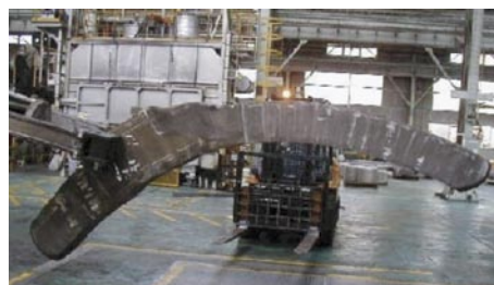
図4 大型自由鍛造品(航空機材用) Large-scale free forging (for aircraft).
