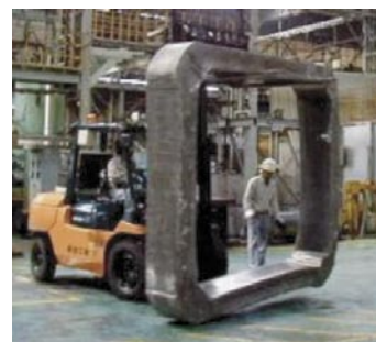
図5 大型自由鍛造品(液晶装置用) Large-scale free forging (for LCD).
