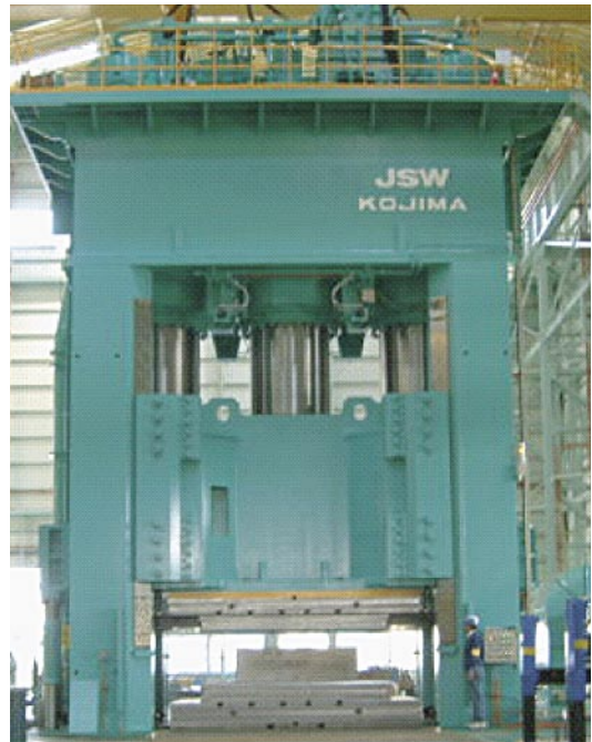
図1 15000トン鍛造プレス 15000-ton forging press.
