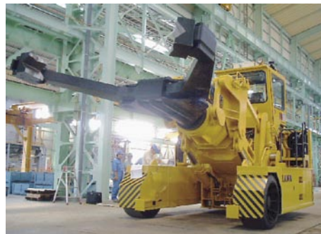
図2 鍛造素材ハンドリング用マニプレータ Manipulator for forged material handling.
