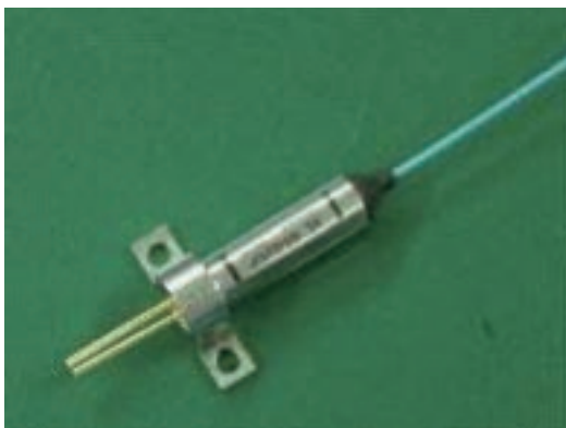
図1 同軸型アンクルドDFBレーザモジュール Appearance of coaxial DFB LD module.
