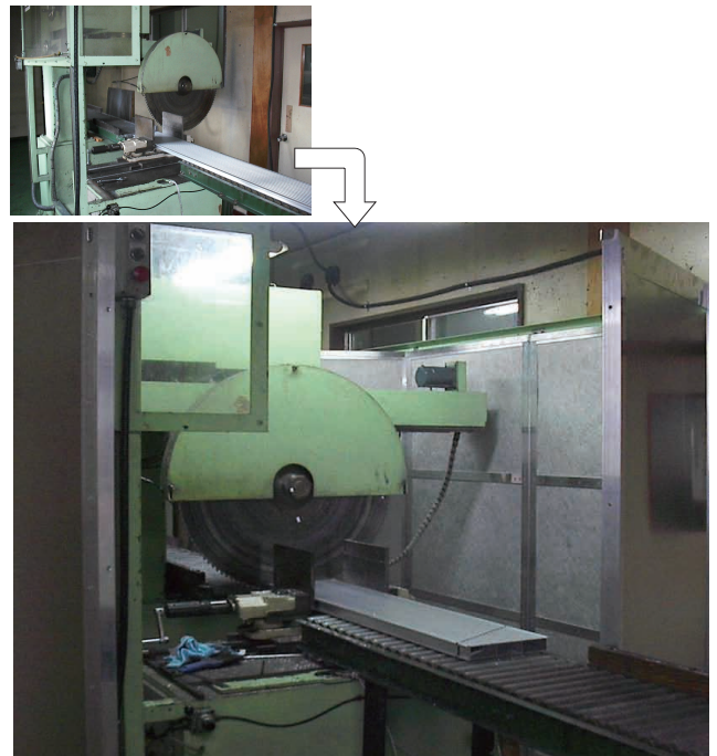
図12 工作機械の周囲に配置した例 FULL POROUS installed around a cutting machine.
