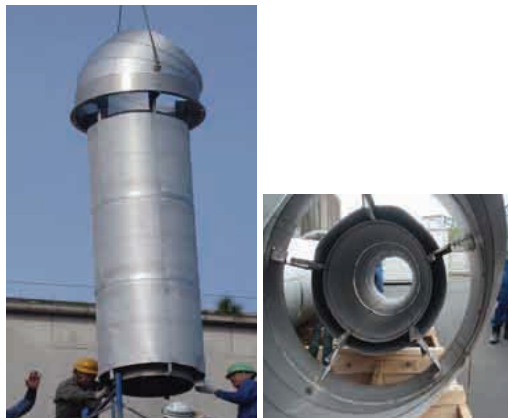
図19-1 大型排気筒に適用した例 (消音機の外観と内部吸音材) Appearance of sound absorber and inner sound absorbing material.
