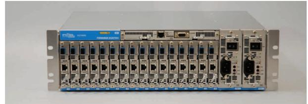
図7 GE-PONセンタ装置 (FITELwave AG1600E)
