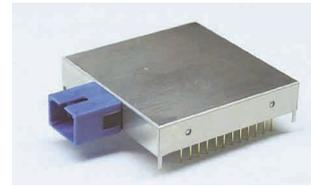
図6 OLT用トランシーバモジュールの外観
