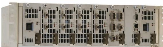
図10 GE-PON延長装置 (FITELwave AG400)
