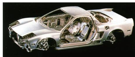
図2 アルミニウム合金ボディシート使用の例(ホンダNSX)
