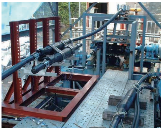
図2 オフセット課通電試験状況 View of offset section in loading test circuit.
