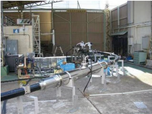
図13 20 m長超電導ケーブルの短絡電流試験
