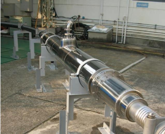
図9 超電導ケーブル中間接続部
