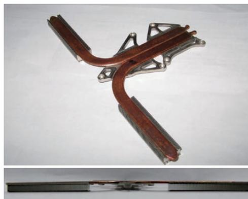
図5 薄型フィンタイプヒートシンク
