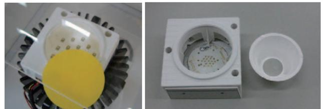
図5 LEDダウンライトモジュールへの適用
