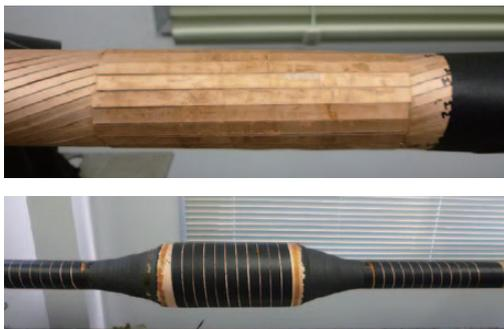
図5 過電流試験に供試した超電導接続部
