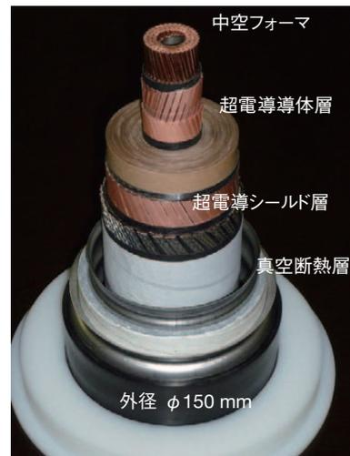
図11 作製した275 kV-3 kA高温超電導ケーブルの外観
