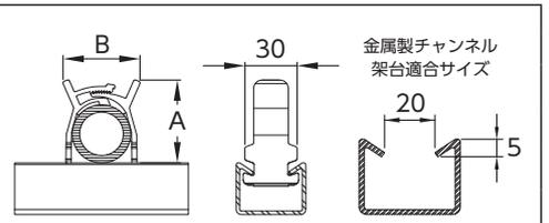
※金属製チャンネル架台は上図の通り、溝幅20mm、掛かり部の高さ5mmに適合しています。
