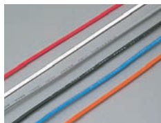
エコ電線 (エコエース) 被覆材に PVC などのハロゲン物質を使用していません。建屋内に使用される汎用電線や電源コードの「エコエース」、機器内用電線「エコビーマックス」、高難燃光ケーブル、などが既に実用化されています。
