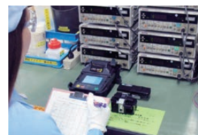
国家標準にトレースされた測定機器による接続損失測定
