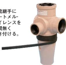
2 ヒートメル-サイレンスの突合せ部分も隙間ができないように押し付けながら巻き付ける。
