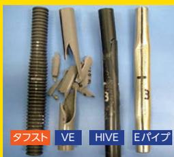
高さ2mから5kgの錘を落下させた耐衝撃試験後のサンプル
