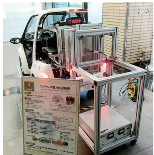
図16 モビリティカーへ搭載したシールドボックス付き電界共鳴型カプラ The electric field resonance coupler with a shield box mounted in a mobility car.
