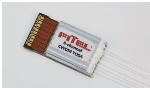
図8 作製した非冷却8チャンネルTOSA Photograph of the 8-channel uncooled TOSA.
