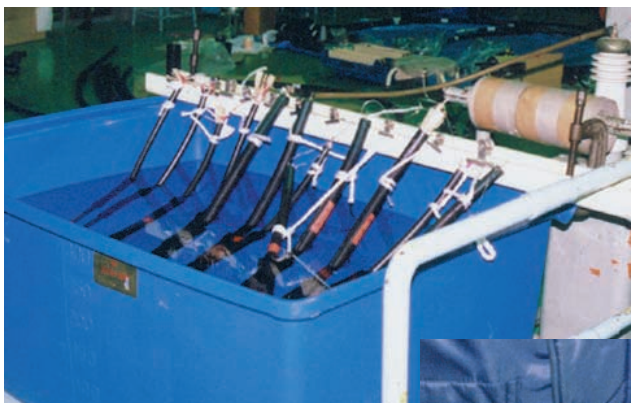
●商用周波耐電圧試験状況(水中)
