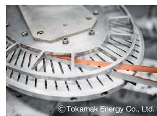
ST-80 电磁线圈的制造
