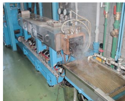
押し出し機ライン
