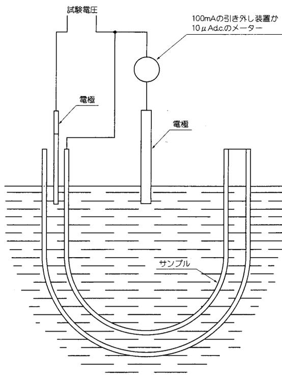
図9 耐電圧及び絶縁抵抗の装置
