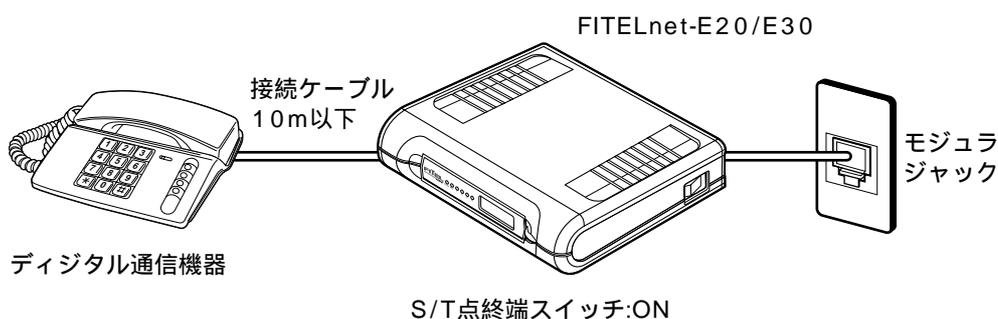
デジタル通信機器の接続が1台で、接続ケーブルが10m以上の場合、および2~7台接続する場合は、S/T点終端スイッチを「OFF」に設定してください。また、本装置から見て、デジタル通信機器接続ジャックに接続した最遠端に位置するモジュラジャックには、必ず終端抵抗付きコネクタを使用してください。
