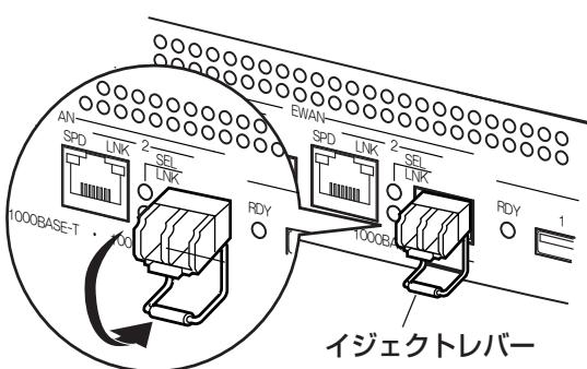
※ 1000BASE-XポートにSFPを挿入する際は、SFPからファイバーケーブルを抜いた状態で行ってください。
