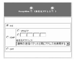
SAが確立されている相手に対して、応答確認を行うかどうかを 設定します。
