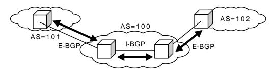
FITELnet-F40で使用するケース(IP-VPN網のアクセスで使用する)を考えてみます。 多くのIP-VPN網は、IP-VPN網内の経路制御にBGPを利用しており、FITELnet-F40でBGP(E-BGP) を動作させることにより、IP-VPN網を含めたダイナミックな経路制御を行うことができます。
