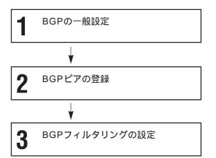
BGPを使用するかどうか、FITELnet-F40が属するASの番号など、BGPを使用する場合に必要なFITELnet-F40側の情報を設定します。
