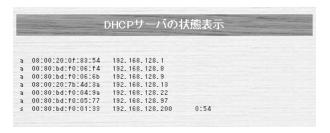
DHCPサーバの状態表示のみかた 表示はIP端末とのペアで表示し、IP端末はIPアドレスで表わしま す。
