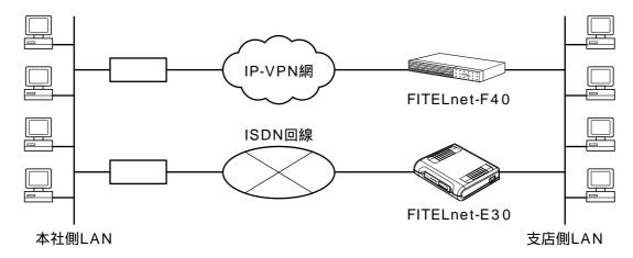
支店側LANから本社側LANへは、通常FITELnet-F40を経由して通信を行うが、IP-VPN網に問題があったり、FITELnet-F40に障害が発生して通信できないような場合は、FITELnet-E30に経路を切り替え、ISDN経由で本社LANに接続する。
