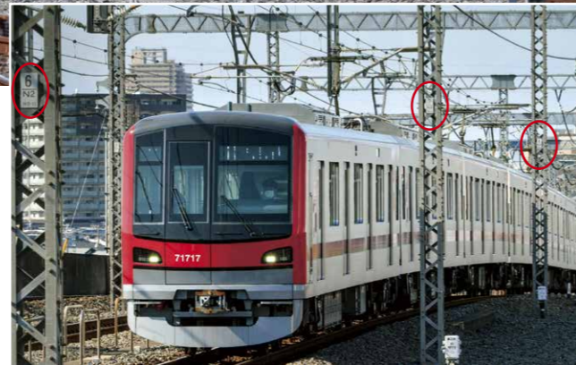
電路柱(架線柱)に設置された柱番号の例(上:北越谷 右:新越谷)
