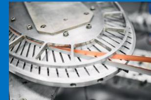
試作中の高温超電導磁石コイル
