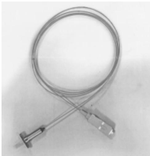
写真2 アナログ用WGPDピグテイルモジュール Photograph of analog WGPD pigtail module
