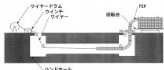
図2 情報BOXへのエフレックス引込み工法 Pulling method of EFLEX into information-cable BOX
