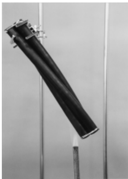
写真 3 難燃傾斜試験風景 Flame retardation test (JIS C 3005)
